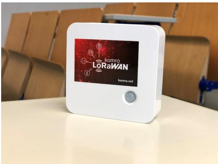
Smarter LoRaWAN Sensor der komro mit langlebiger Batterie und kompakten Abmessungen (BxHxT 8,5 x 8,5 x 2,5 cm)
